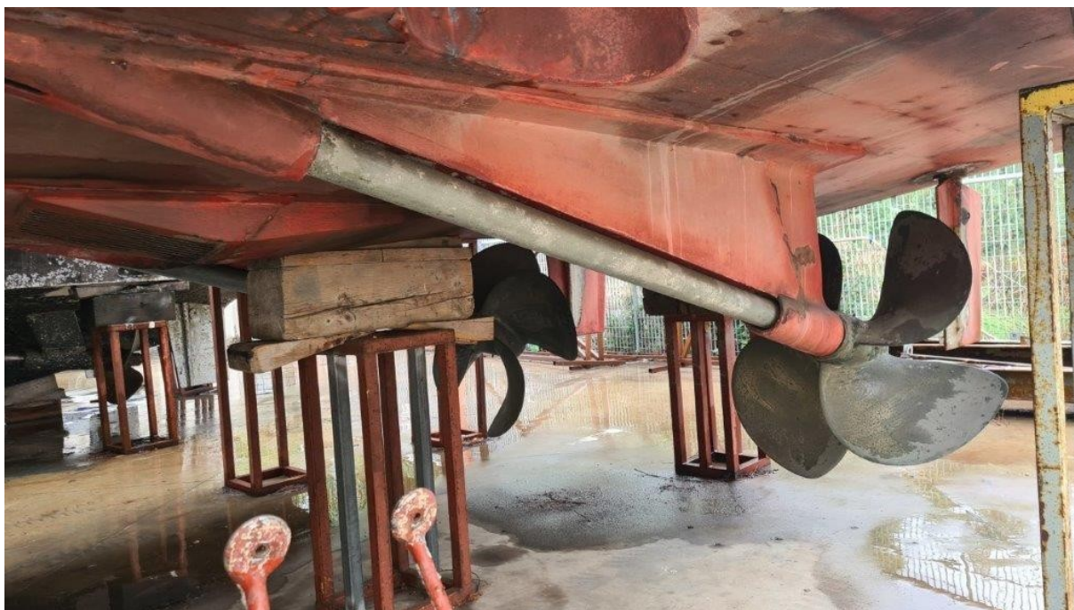
Figura 5 - 4 – Linea d'asse semicarenata
