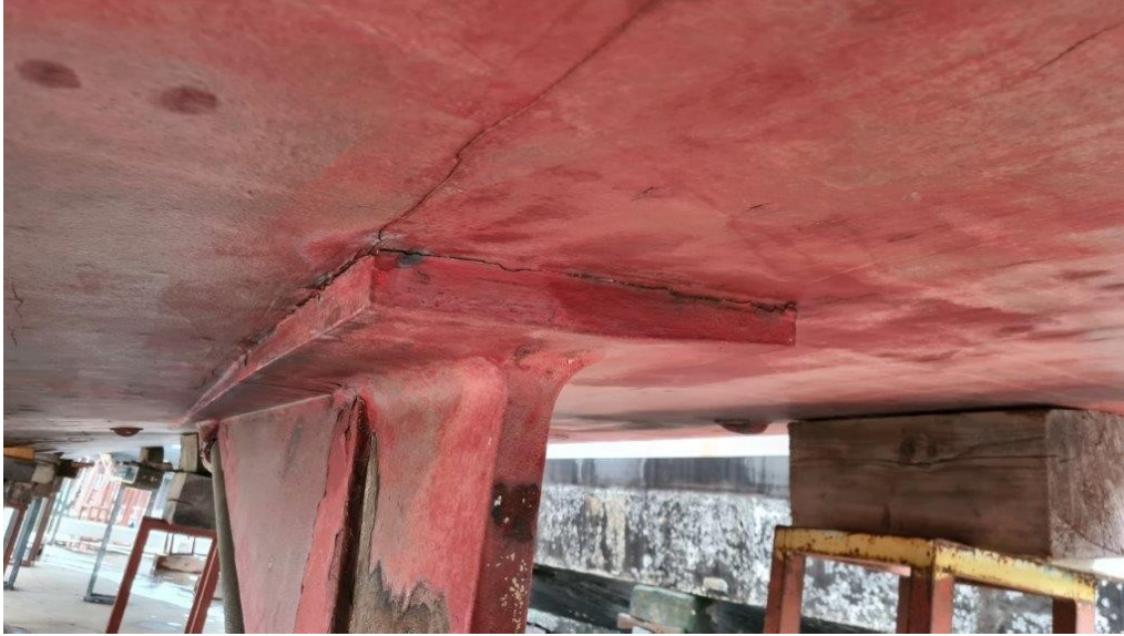
Figura 5 - 5 – Accoppiamento cavalletto porta-asse Lato Dritto
