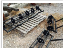
#54: Rouleau à cage pour vibrocultivateur
