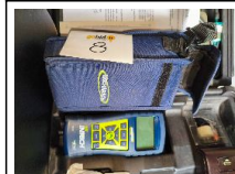
#16: Analizador de combustión Bacharach
